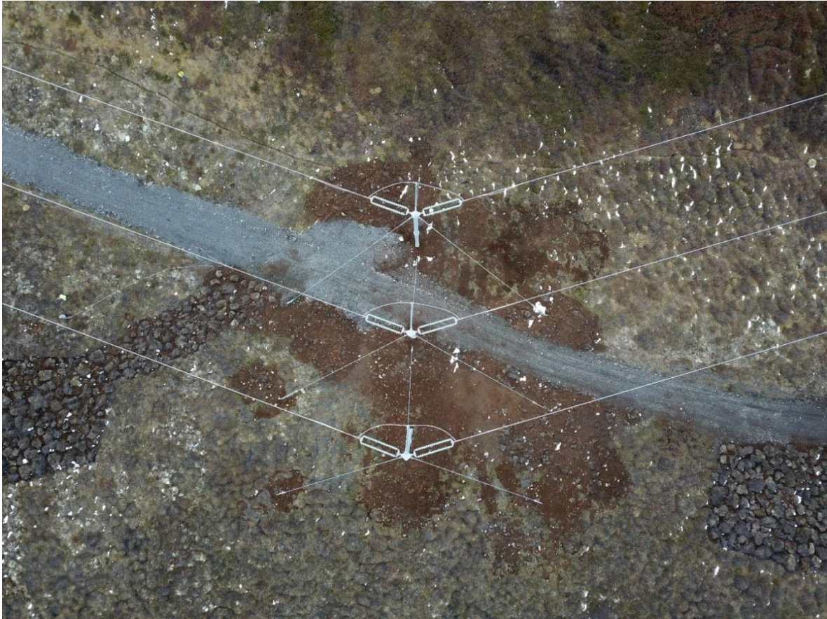
Mynd 6.6 Drónamynd af slóð og vinnuplani hornmasturs í Þeistareykjalínu 1. Myndin er tekin ári eftir að framkvæmdum lauk.
